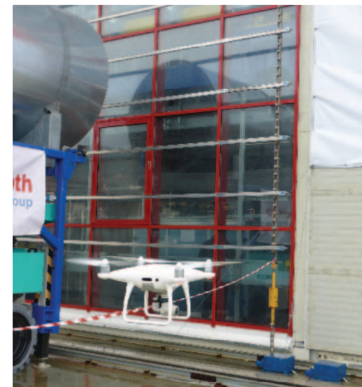
Anche la telecamera del drone conferma la tenuta della SL50.
