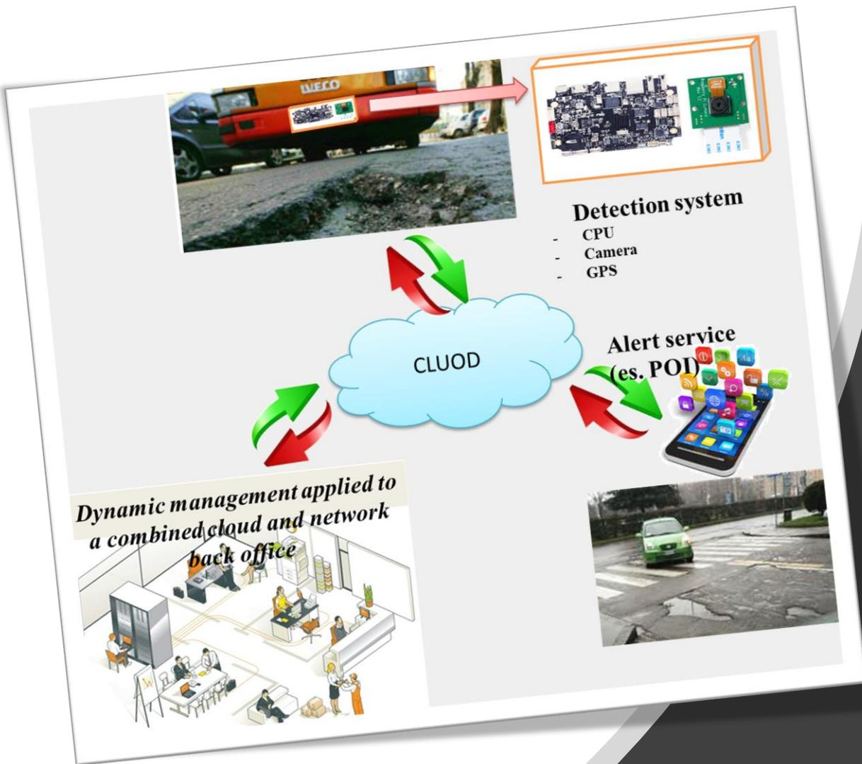
Asphalt 2.0 è un dispositivo molto compatto e versatile che consente mappatura dei difetti del manto stradale all'interno di un sistema informativo, in grado di rilevare la gravità del pericolo e di comunicarlo prontamente alle autorità responsabili della sicurezza stradale per attivare le procedure per la manutenzione o le opportune segnalazioni di pericolo
