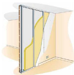
Questo tipo di intervento presenta ovviamente dei limiti legati innanzitutto alla perdita in termini di superficie calpestabile e inoltre la riduzione della trasmittanza termica va a scapito delle caratteristiche inerziali della parete. Non si eliminano i ponti termici sulle testate delle solette e negli angoli di incrocio di queste con le pareti verticali.
