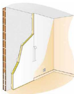
La seconda metodologia di intervento (destinata a pareti con intercapedine) è rappresentata dalla possibilità di effettuare un riempimento della cavità utilizzando materiali isolanti sfusi quali argilla o vermiculite espansa, sughero in granuli, fibra di cellulosa, lana di vetro nodulata o mediante schiume espansive ureiche o poliuretaniche.
